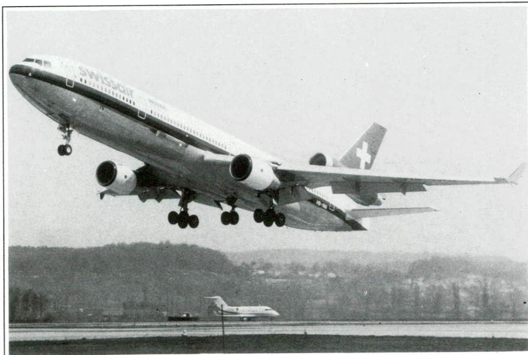
O novo trijato MD-11 da Swissair decola. Repare nas "winglets", pequenas aletas laterais, que mais nitidamente o diferenciam de seu antecessor DC-10.
